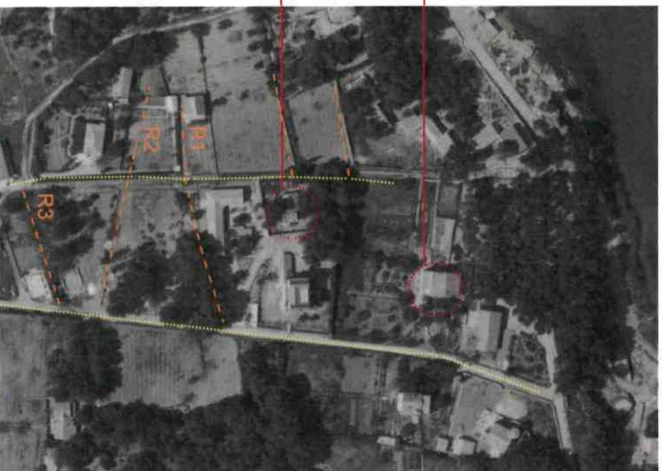
1952 - Sans doute pour la construction du bâtiment annexe, la restanque R1 a pu être modifiée. On voit en effet actuellement des pans coupés sur cette restanque. Les modifications ont pu être liées aux terrassements nécessaires pour la construction et ont sans doute fait l'objet de création de nouveaux murs de soutènements
